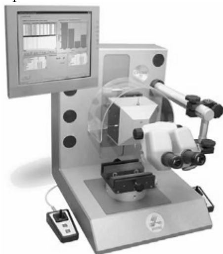
а – тестер соединений Condor
