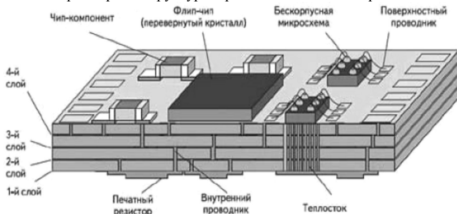
Рисунок 2 – Пример многослойной керамической структуры
