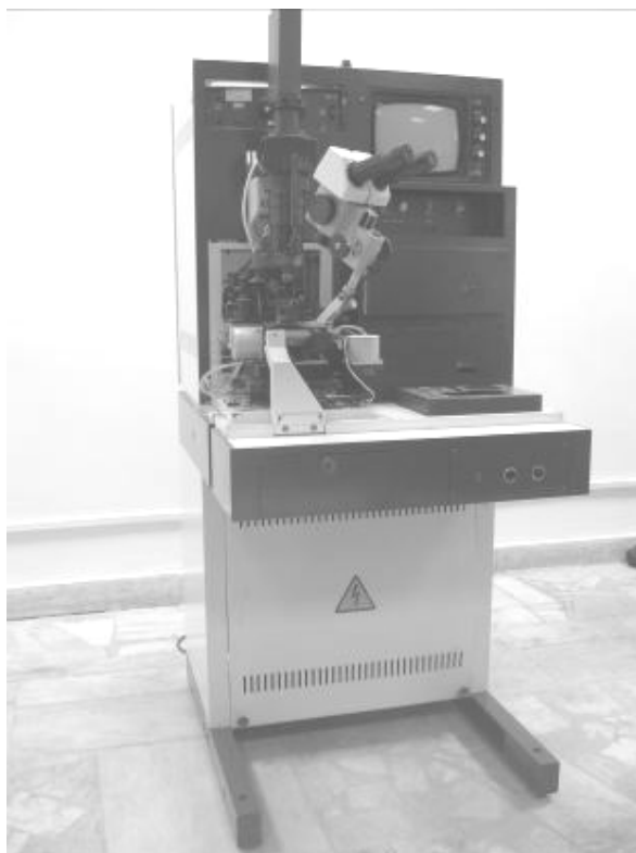
Рисунок 5 – Установка микросварки УЗСА-12
