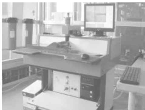
Рисунок 5 – Установка дисковой резки ЭМ-225 с модернизированной системой управления
