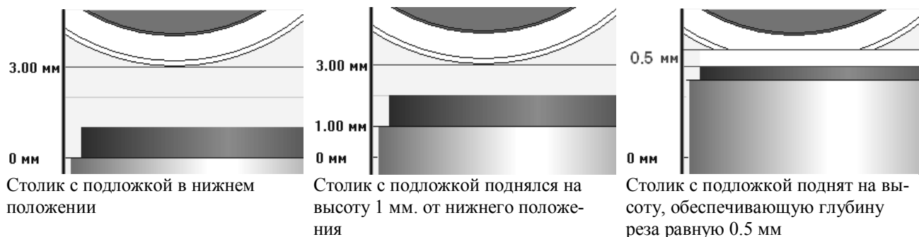
Рисунок 6 – положения столика с подложкой относительно режущего диска
