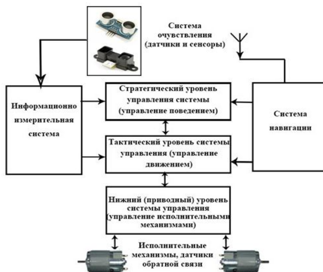
Рисунок 1 – Структура систем управления мобильного робота
