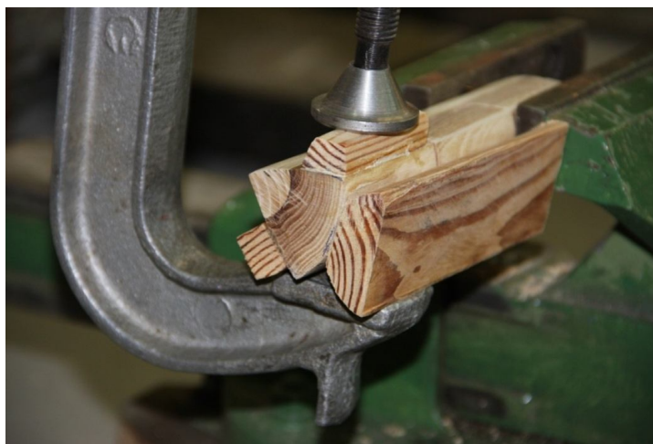
Рис. 2. Приклеивание детали «плавник»
