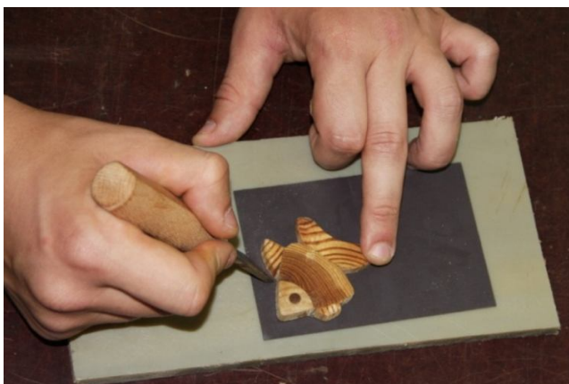
Рис. 4. Обрезание по контуру «магнитной» подложки
