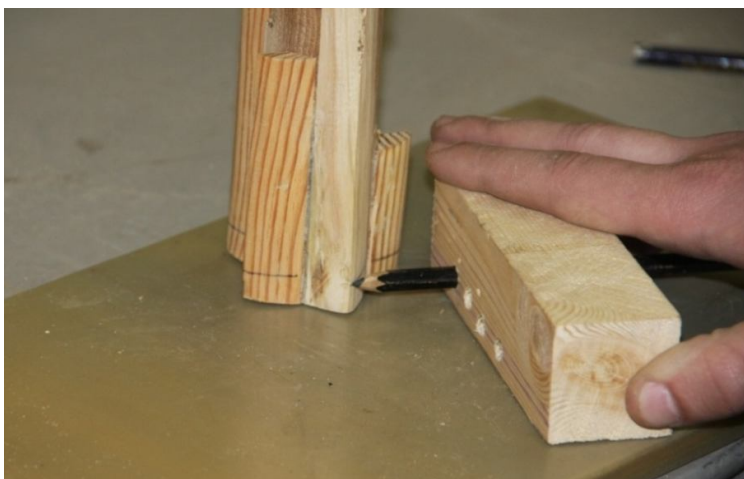
Рис. 3. Разметка изделия с помощью специального приспособления
